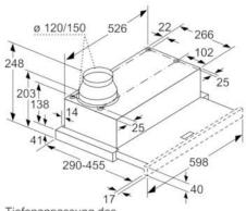
Tiefenanpassung des Filterauszuges bis 29 mm möglich
