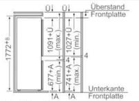
Bei größeren Maßen (1780 - 1790) muss an der Nischendecke eine Distanzleiste vorgesehen werden. Die angegebenen Möbeltürmaße gelten für eine Türfuge von 4mm. Bei Verwendung einer anderen Fugenbreite (max.14mm) müssen die Maße angepaßt werden.
